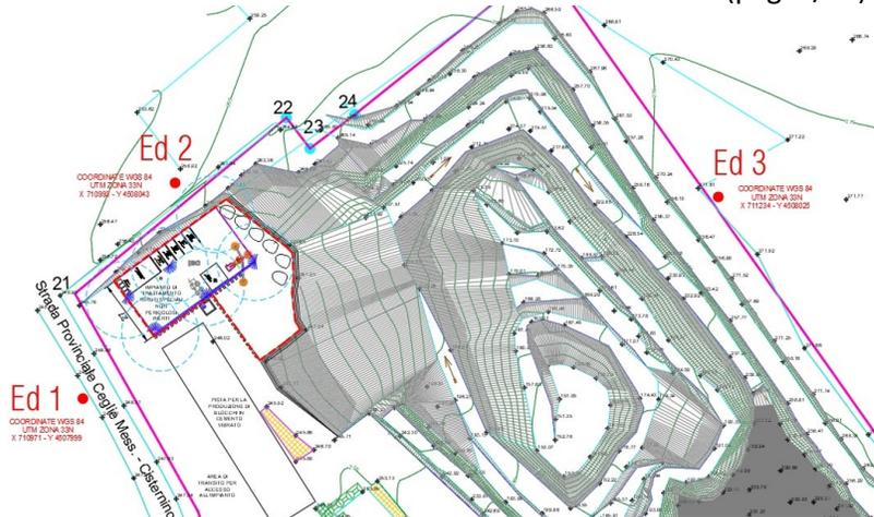
Fig. 4.- planimetria con la posizione dell'impianto e dei nuovi punti di campionamento delle emissioni diffuse.
